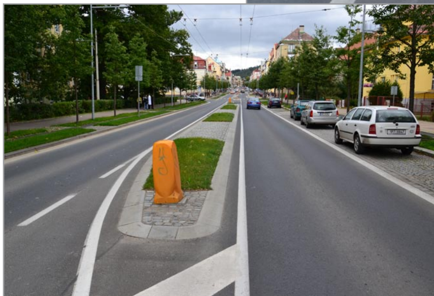
Obrázek 10: Dělicí pás mezi křižovatkami Hlavní třídy s ulicí Lužická a Komenského pohledem směrem k Chebské křižovatce. Na snímku patrné jednostranné směřové vychýlení pásu díky vychýlené ploše zastávky. ▲
