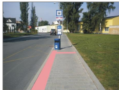
— Obrázek 61: Na zastávce MHD zcela chybí úpravy pro bezbariérové užívání (signální pás u označníku, vizuálně kontrastní pás podél nástupní hrany), (Brno).
