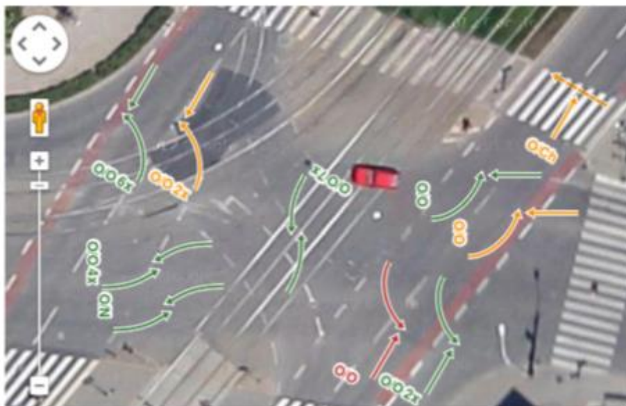
Příklad části konfliktního diagramu na podkladu ortofotomapy
