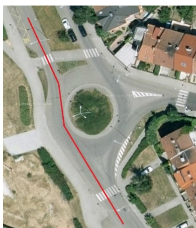
obr. 03. Nevhodně navržená OK – možný přímý průjezd
