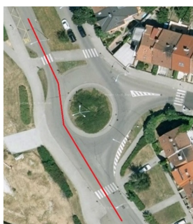
obr. 03. Nevhodně navržená OK – možný přímý průjezd
