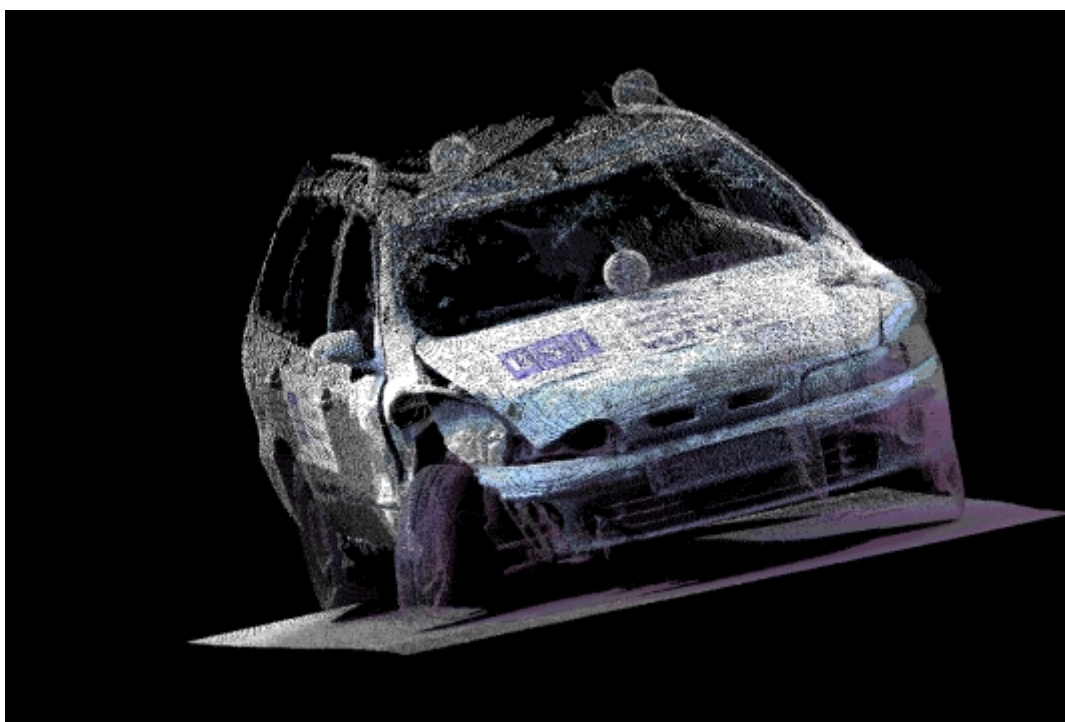
Obr. 3 - Fotografická interpretace 3D modelu havarovaného vozidla
