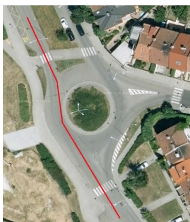
obr. 03. Nevhodně navržená OK – možný přímý průjezd
