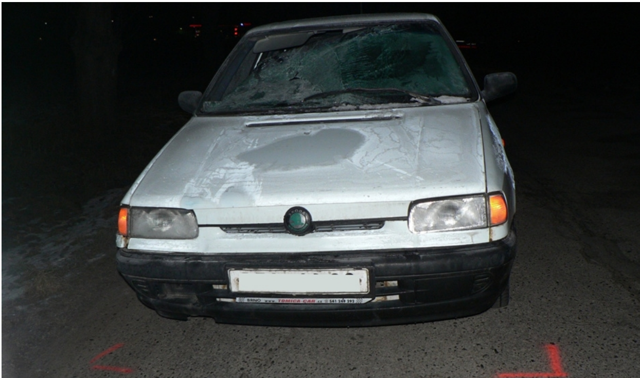
Obr. 2.6 - Zanedbání přípravy vozidla před jízdou (neočištěná námraza na předním skle)
