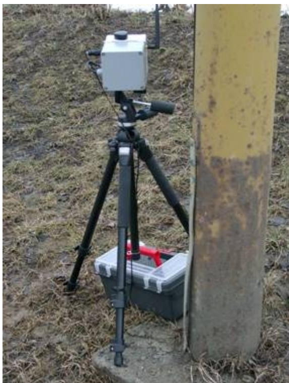
Obrázek 4 – Radar umístěný za sloupem veřejného osvětlení
