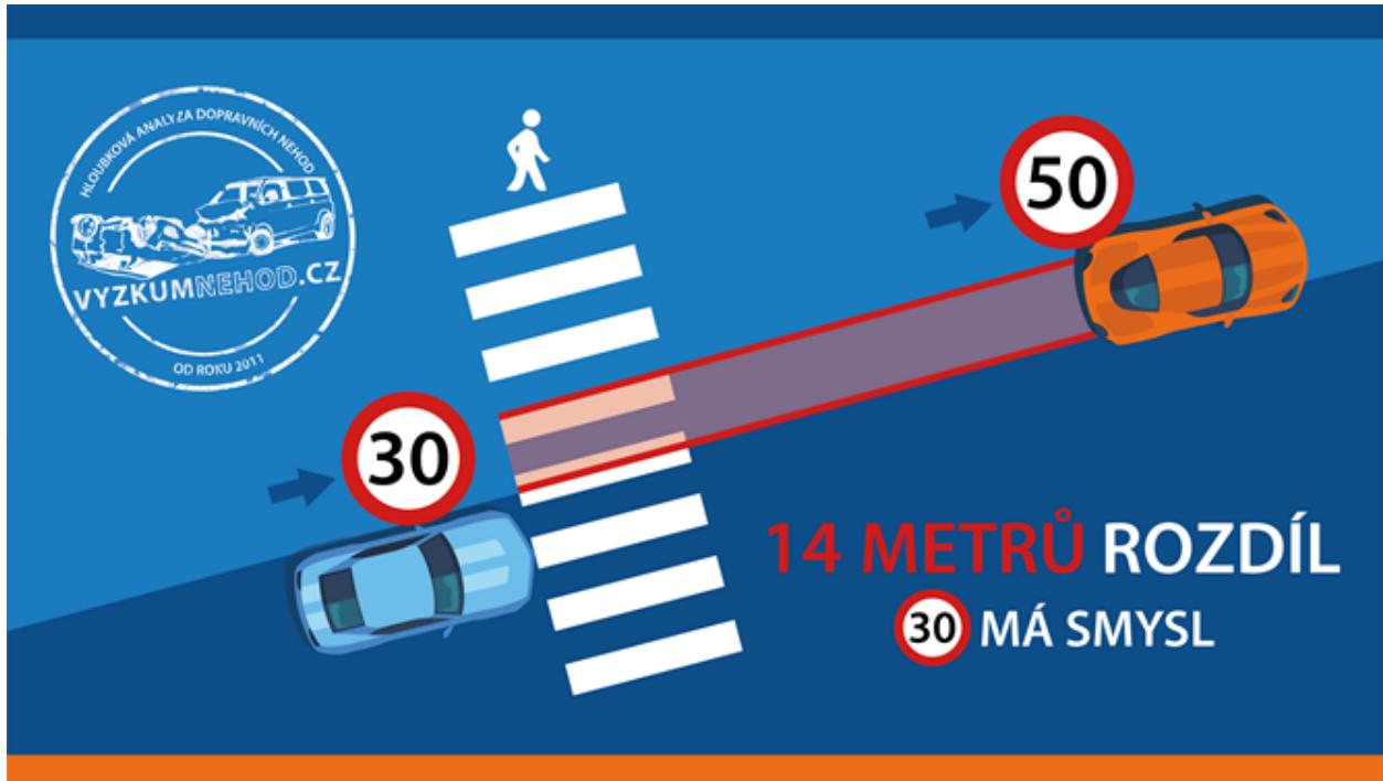
Pozn. Rozdíl je kvantifikován z technických podmínek 218: Navrhování zón 30. Jedná se o orientační hodnotu, která je závislá na typu povrchu vozovky (suchá, mokrá, sníh apod.), reakční době řidiče a brzdné dráze vozidla.
