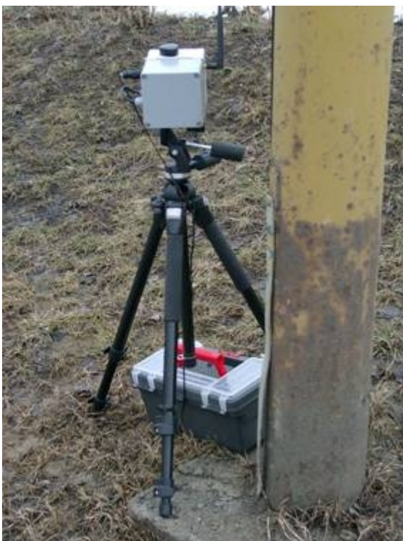
Obrázek 4 – Radar umístěný za sloupem veřejného osvětlení
