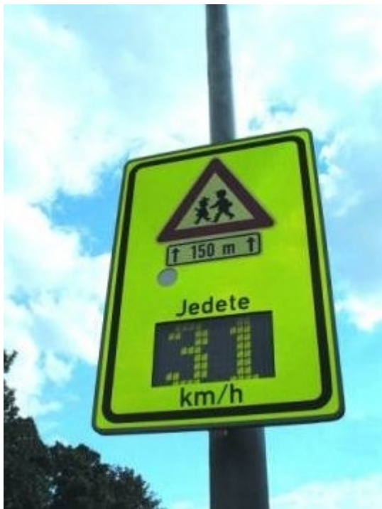
Obr. 1: dopravní zařízení doplňující svislou dopravní značku
