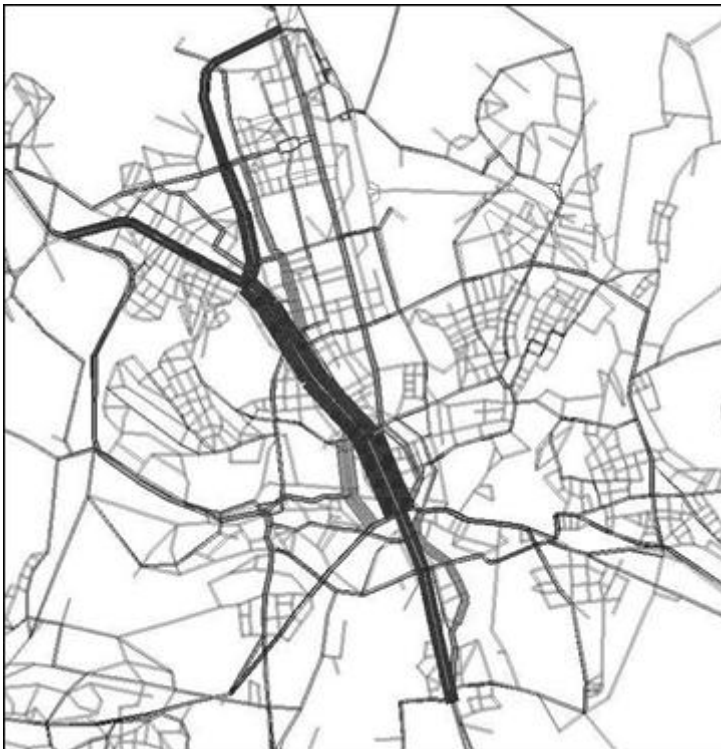
Obrázek 6 Vliv stavby SJTD na změnu přepravních toků ve veřejné dopravě (barvy vyjadřují změnu v dopravních objemech: tmavá - nárůst, světlá - pokles a síla čáry představuje velikost).
