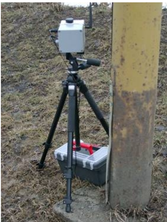
Obrázek 4 – Radar umístěný za sloupem veřejného osvětlení
