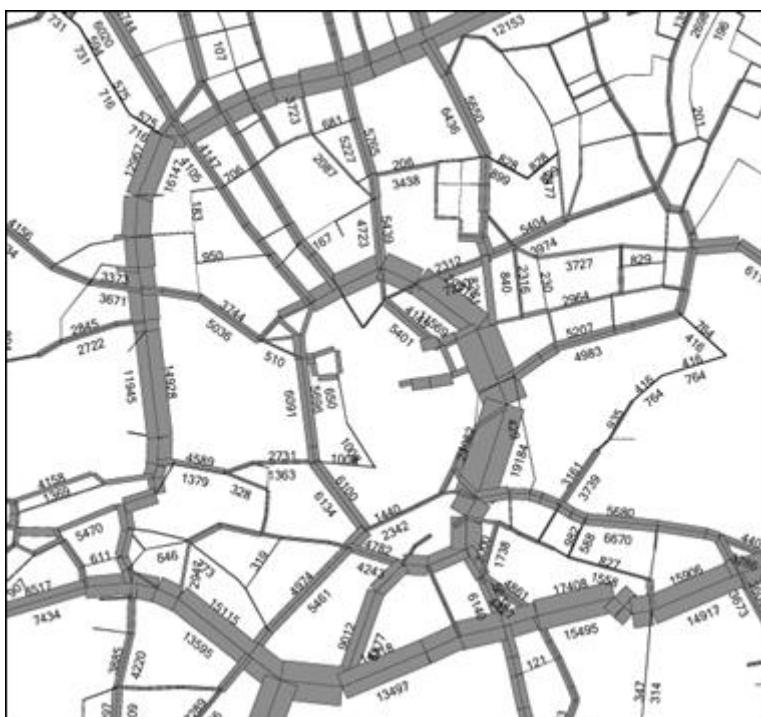
Obrázek 1 Výsledky modelování dopravních objemů v centru Brna.
