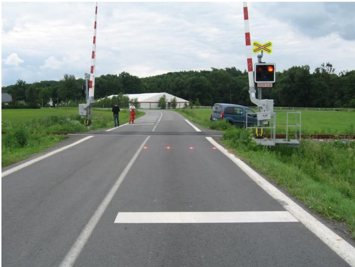
Obr. 4 - Světelná závora v Otčích
