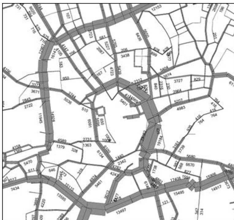
Obrázek 1 Výsledky modelování dopravních objemů v centru Brna.
