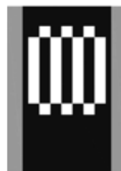
Sdružený přechod pro chodce a přejezd pro cyklisty V 8c
